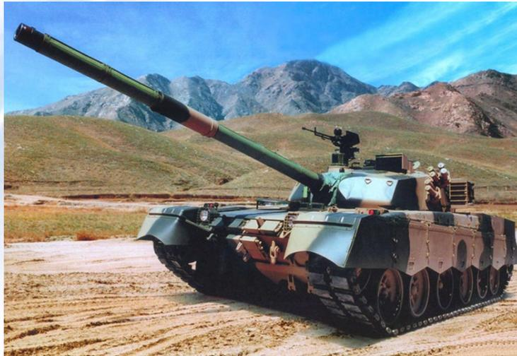
中国自行研制的第三代主战坦克 ZTZ-99A，全重超过50吨，最大穿甲能力850-970毫米，正面防护达到1200毫米。
