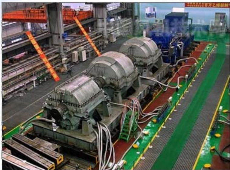
百万吨级乙烯裂解气压缩机组
