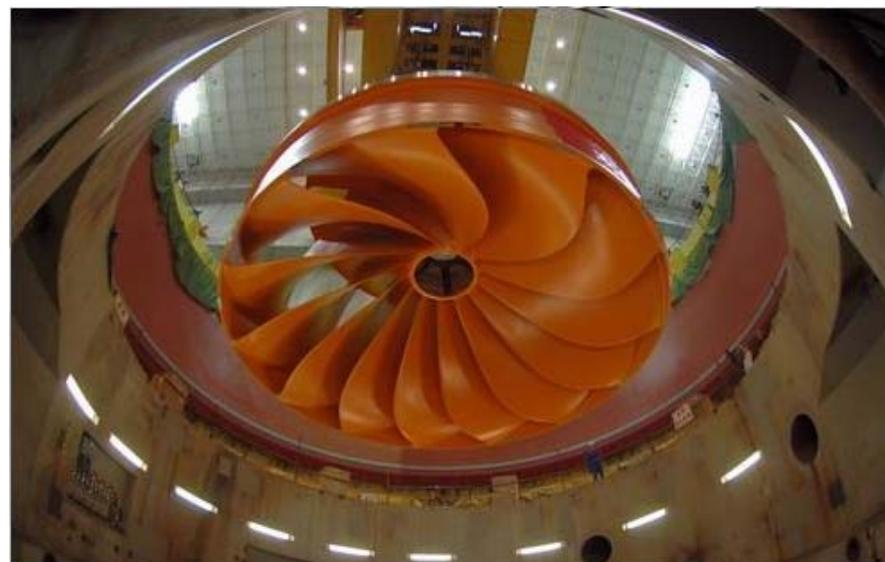
我国独立设计制造的三峡工程中具有世界先进水平单机容量**70万KW**水电机组，总装机**1820万KW**，年发电量**847亿千瓦时**。
